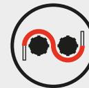
**08** Nutzung von biegeweichem Kantenschutz bei Umlenkungen und engen Durchlässen!
